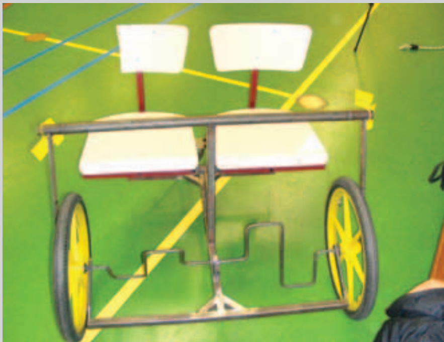
Foto 1. Tandemdriewieler met twee wielen voor (winnend prototype 2007/2008)
